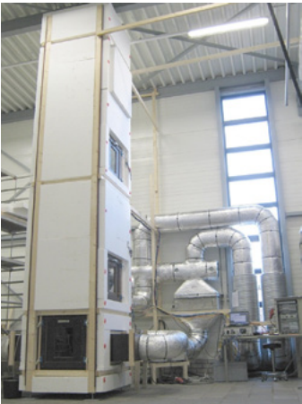
Testopstelling Klimaatcascade in het lab van Peutz
