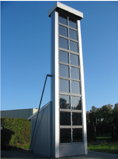
Proefopstelling van een zonneshoorsteen
