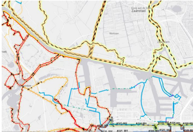
Figuur 4-5 Overzicht waterkeringen. Een ligging van de waterstofleiding direct ten noorden van het Noordzeekanaal is vanwege beschermingszone van de primaire waterkering niet mogelijk. Een iets noordelijkere ligging kruist diverse waterkeringen.
