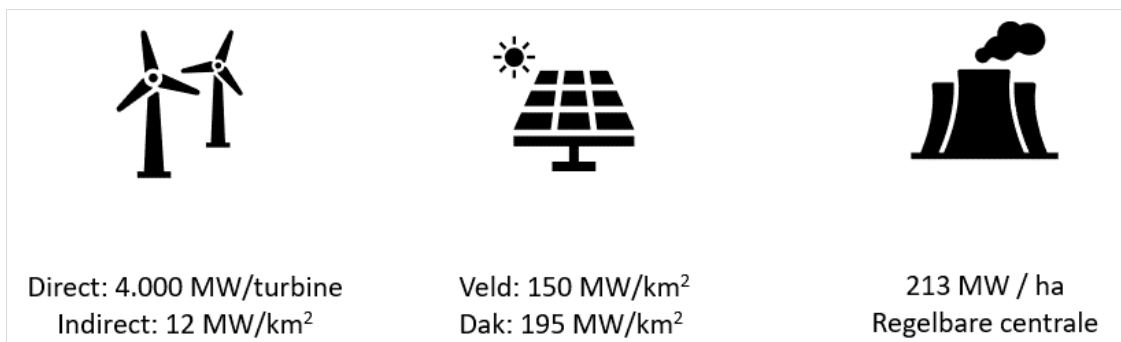
Figuur 2-1 - Overzicht ruimtegebruik opwek
