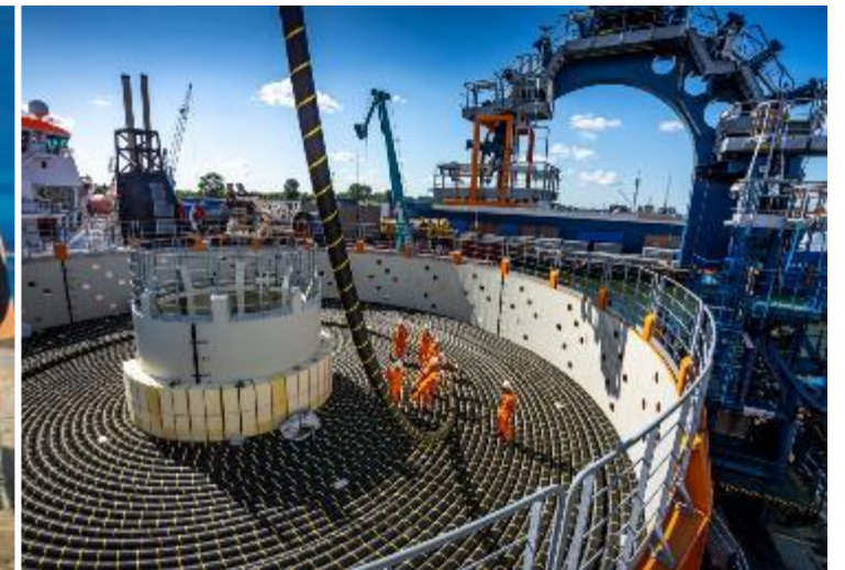
Gebundelde HVDC 525 kV submarine kabelconfiguratie
