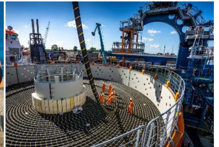
Gebundelde HVDC 525 kV submarine kabelconfiguratie
