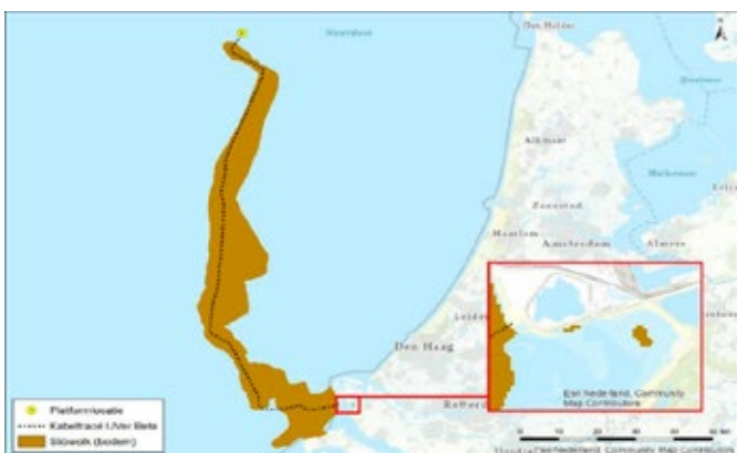
Figuur 4-1 Gebied tot waar de slibwolk (> 2 mg/l) maximaal reikt nabij de bodem ten gevolge van de werkzaamheden van Net op zee IJmuiden Ver Beta
