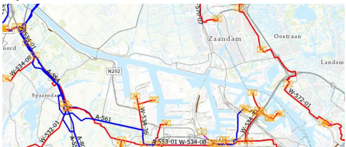
Figuur 4-4 Overzicht gastransportleidingen t.b.v. (on)mogelijkheden bundeling. Ten noorden van het Noordzeekanaal zijn er geen gastransportleidingen waarmee gebundeld kan worden.
