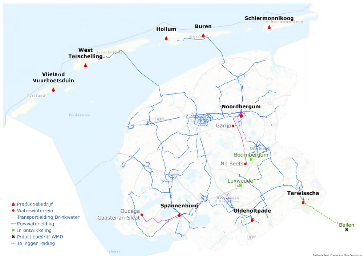
Figuur 1.1. Huidige drinkwaterwinningen en distributienetwerk (hoofdleidingen).
