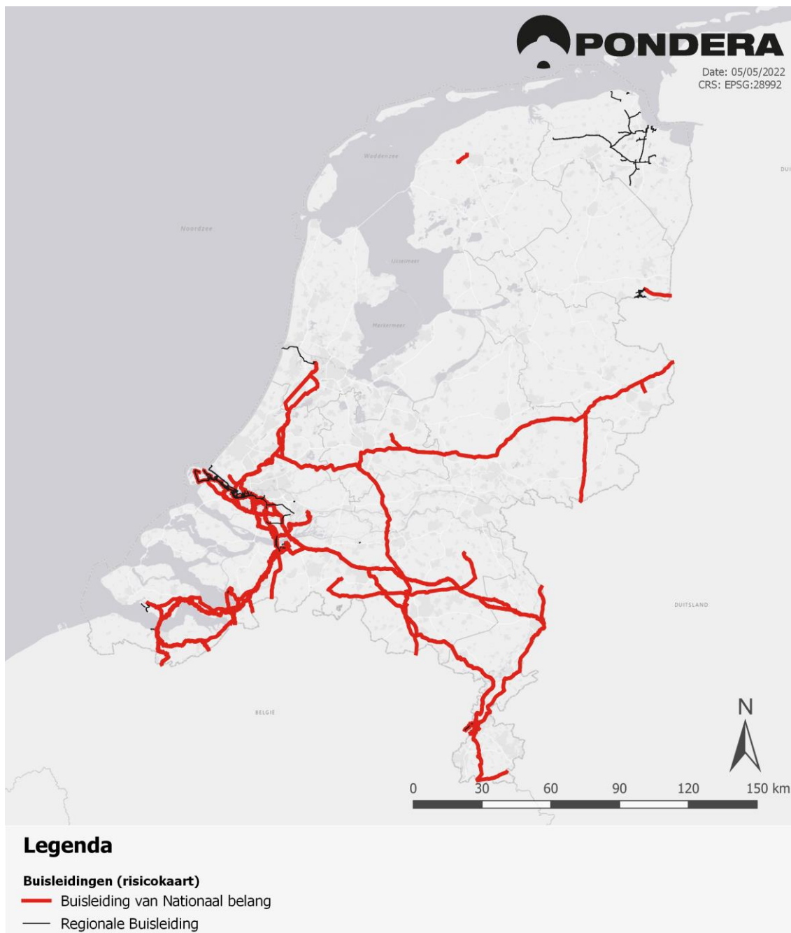
Figuur 0-2 - Overzichtsk kaart van de huidige 'overige' buisleidingen. In het rood de buisleidingen van nationaal belang, in het zwart de regionale buisleidingen
