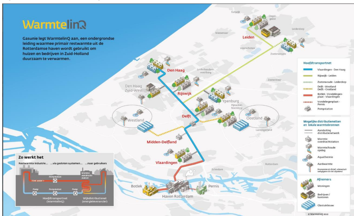
Figuur 5-2 - Overzicht van leidingen binnen WarmtelinQ
