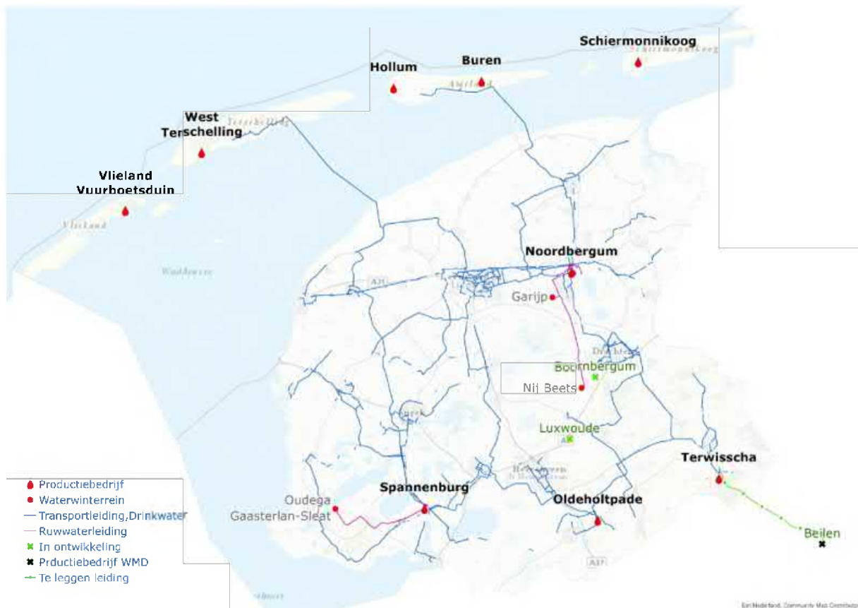
Figuur 1.1. Huidige drinkwaterwinningen en distributienetwerk (hoofdleidingen).
