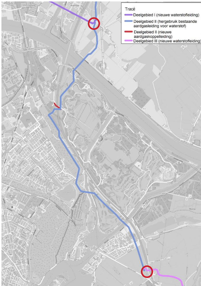
Figuur 2-6 Ligging bestaande voor waterstof in te zetten gastransportleiding in deelgebied II met afsluiterlocaties aangegeven met rode cirkels
