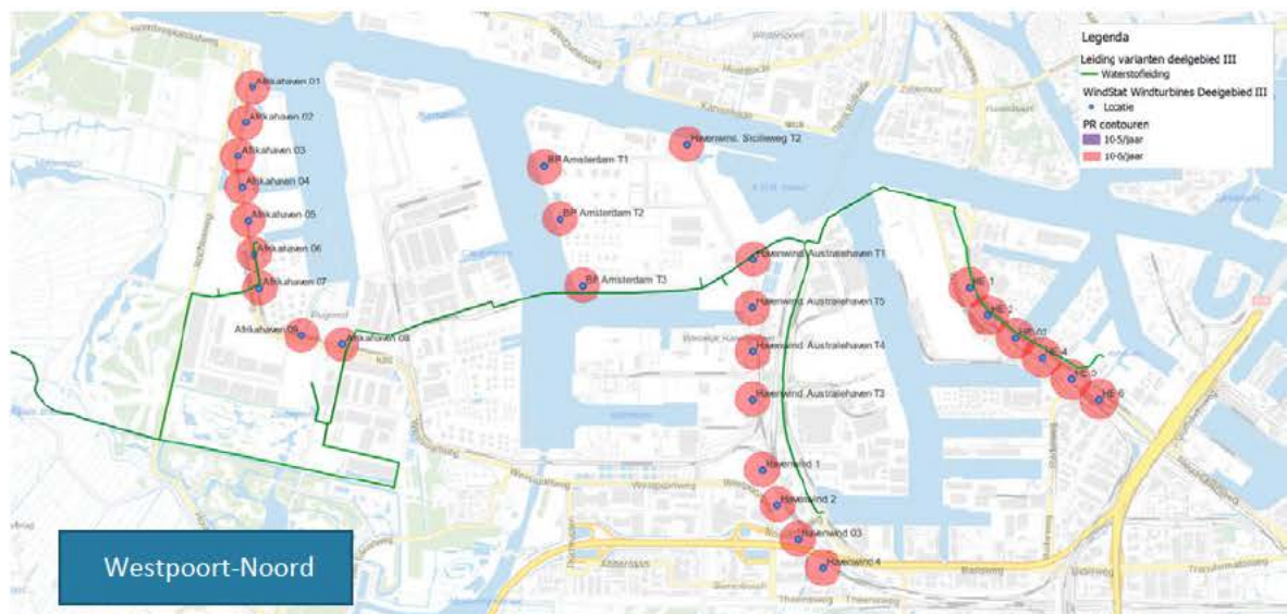
Figuur 8-29 Ligging variant Westpoort-Noord ten opzichte van bestaande windturbines en hun risicocontouren (bron: Antea Group, 2023)
