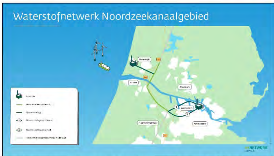
Figuur 1.1 Weergave van het voornemen als onderdeel van de voorgenoemde landelijke waterstofinfrastructuur (bron: HNS)
