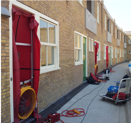
Figuur 1 Luchtdichtheidsmetingen ofwel blowerdoortesten; woningbouwcomplex Justus van Effen te Rotterdam
