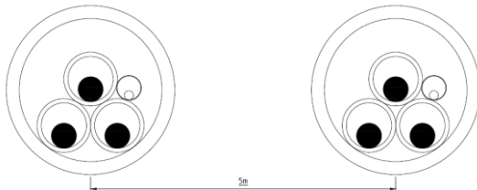
Figuur 4: Eén 150 kV circuit doorsnede bij een boring
