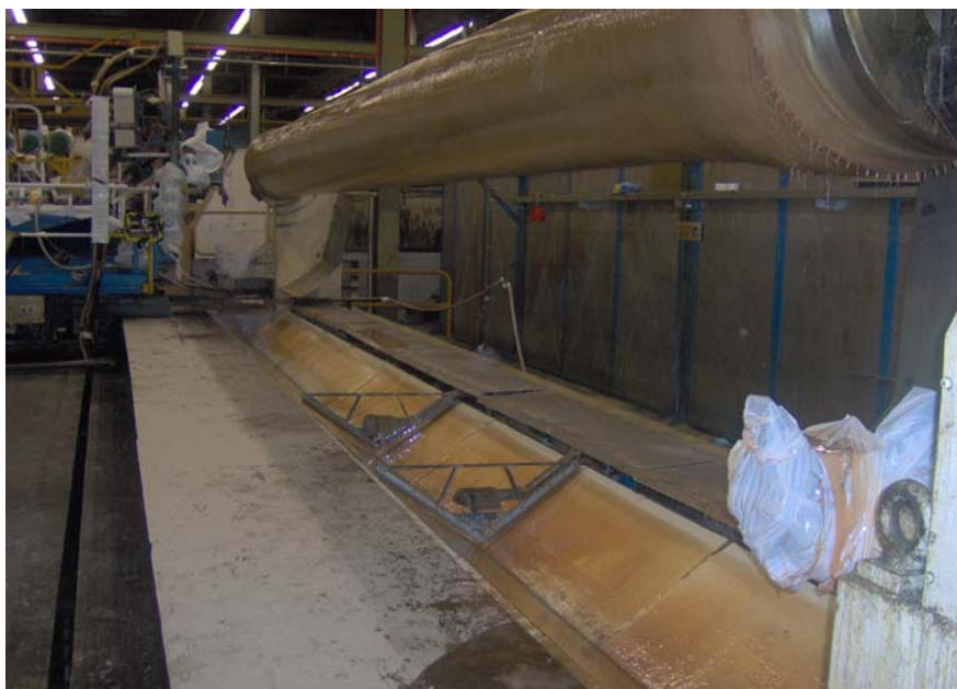
Fig. 2.1.1 Kruislings wikkel proces
