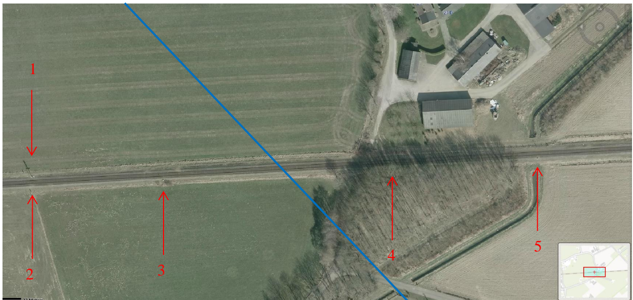
Afbeelding 3, Locaties van infra systemen: 1) Sein 192, 2) ATB-NG baken 00675, 3) Assenteller ADP A27.5, 4) ATB-NG baken 04286, 5) Assenteller ADP A27.4
