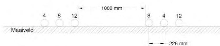
Afbeelding B5, Klokgetallen configuratie kabelgedeelte (maaiveldligging)
