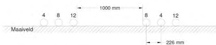
Afbeelding B5, Klokgetallen configuratie kabelgedeelte (maaiveldligging)
