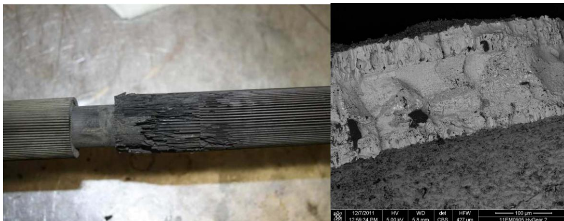
Figuur 5: gecorrodeerde warmtewisselaar met SEM beeld (rechts)
