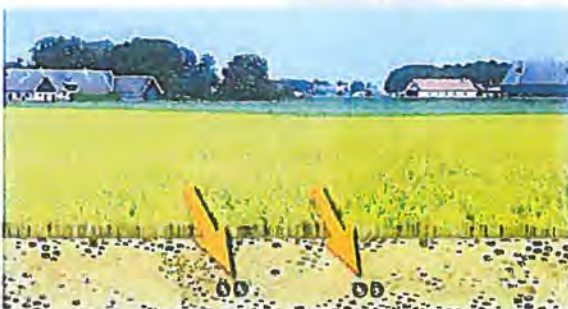
Onzichtbare energietransmissie met HVDC Light ® spaart landschap en milieu en geeft geen waardeverlies. Bovenstaande Australië toont een verbinding in redundante uitvoering.
