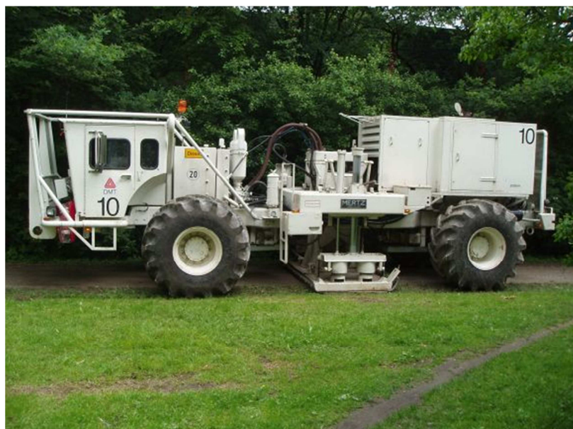
Figuur 21. Met vibro-trucks worden via een plaat op de bodem drukgolven door de ondergrond gestuurd. Er zijn meerdere trucks nodig.
