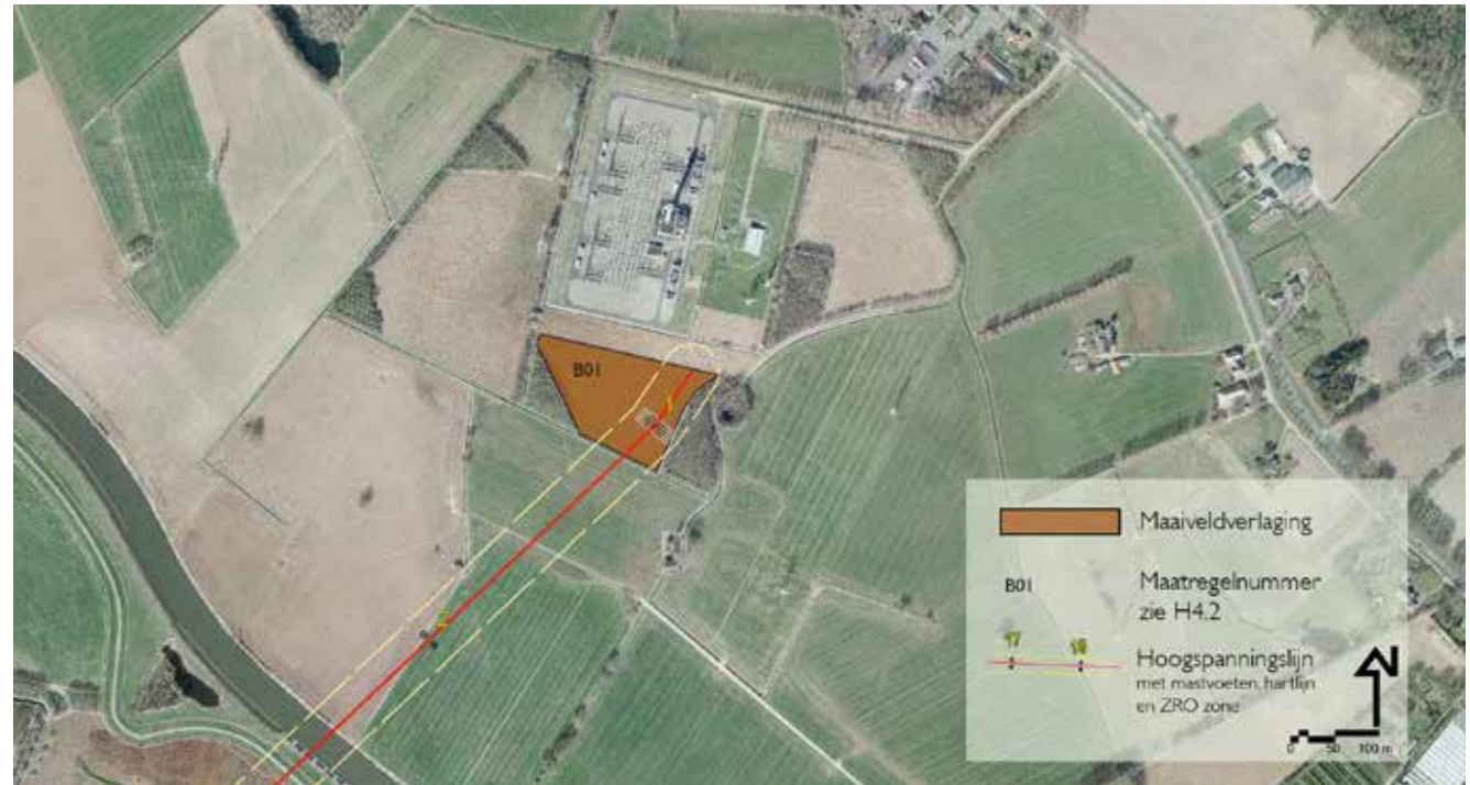
fig: 8 Maaiveldverlaging als compensatie voor de uitbreiding van het hoogspanningsstation
