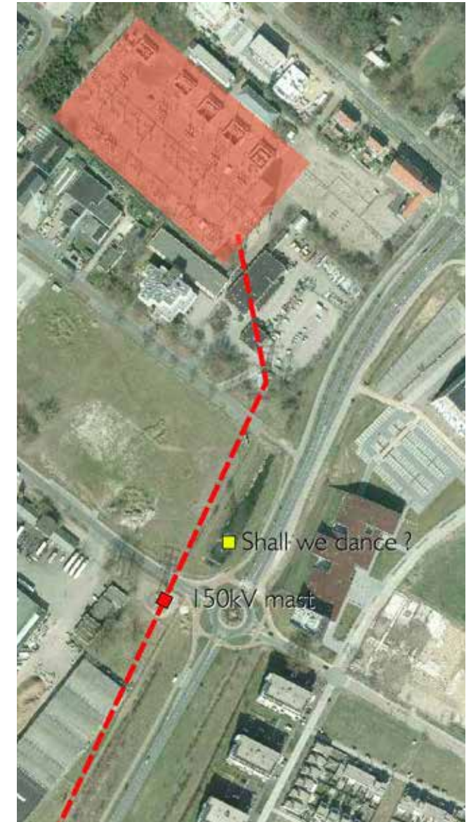
fig.: 15 Situatie aan de Energieweg in Doetinchem. Het rode vlak is het 150kV station, de rode streeplijn en de rode vierkanten is de bestaande 150kV lijn. De gele rechthoek is het kunstwerk: Shall we Dance.
