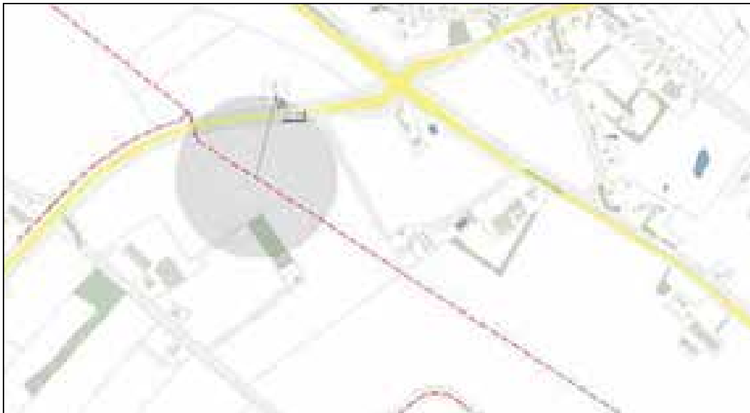
Figuur 3: buisleiding locatie 2 met kortste afstand tot een woonfunctie (circa 155 meter)
