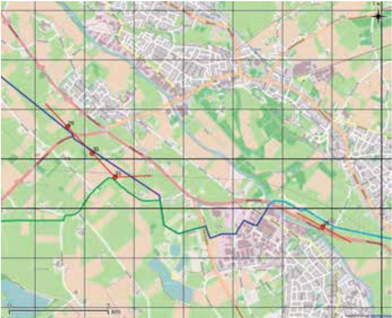
Figuur 1 Ligging van de beschouwde gedeelten van gastransportleidingen N-565-19 (donkergroen), N-566-01 (donkerblauw) en N-569-80 (lichtblauw) en hoogspanningsmasten 29, 30, 31 en 38 (rood), tevens is de lijnrichting per hoogspanningsmast weergegeven.
