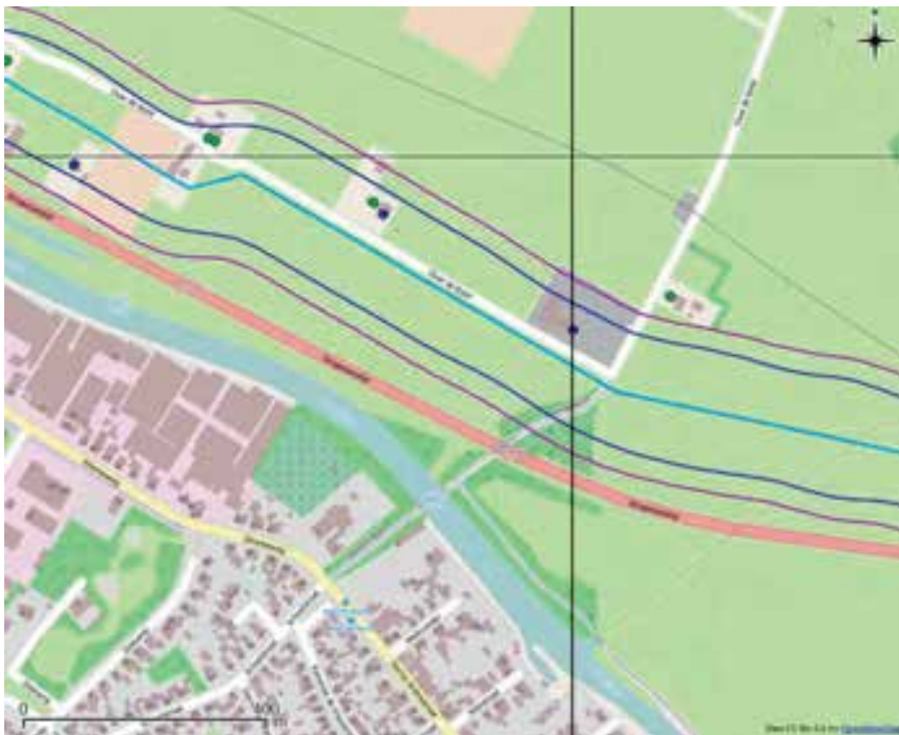
Figuur 8 Ligging van gastransportleiding N-569-80 (lichtblauw). De plaatsgebonden risicocontouren rondom de leiding zijn, wanneer aanwezig, weergegeven met de volgende kleuren:
