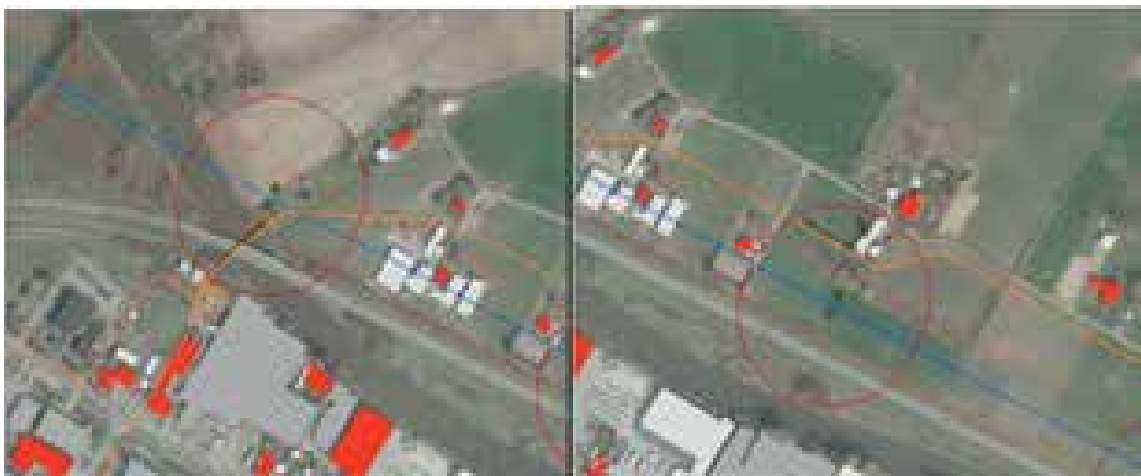
Figuur 3.5 Omvalcriteria van hoogspanningsmasten 36 en 37 Per mast zijn twee pylonen aangegeven en is de valcirkel van een mast in rood gemarkeerd. De Gasleiding is oranje [2].
