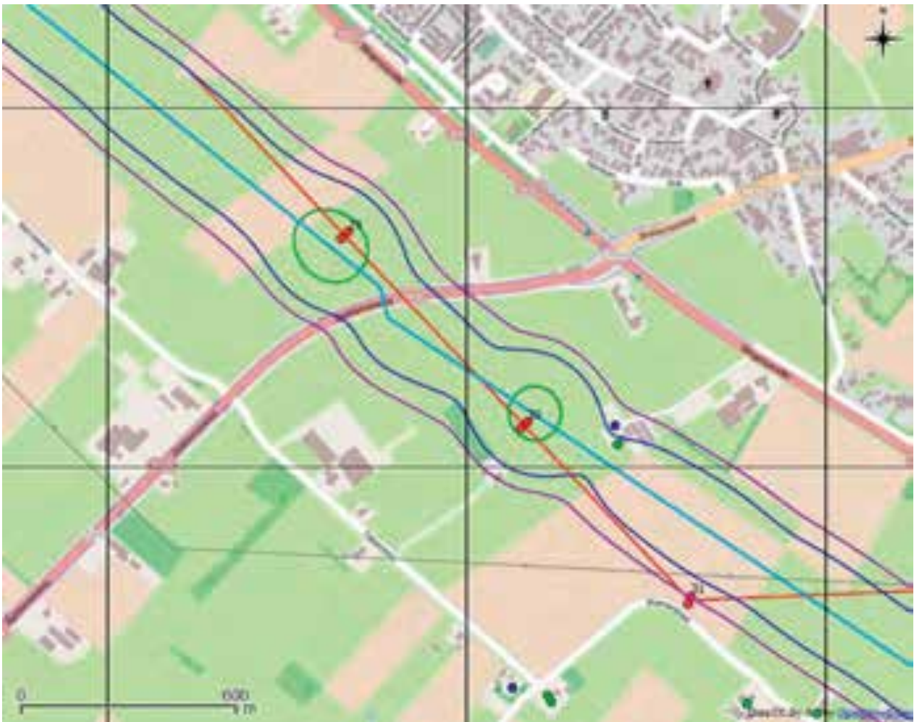
Figuur 9 Ligging van gastransportleiding N-566-01 (lichtblauw). De masten en de hoogspanningslijn zijn weergegeven met rood. De plaatsgebonden risicocontouren rondom de leiding zijn, wanneer aanwezig, weergegeven met de volgende kleuren:
