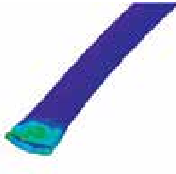
Figuur 4.6 Visualisatie bij de maximale penetratie door betonnen hoogspanningsmast W4S450 (de leiding is apart weergegeven, PEEQ is plastische equivalente rek)
