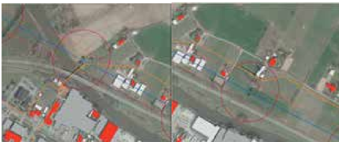
Figuur 1.5 Omvalcriteria van hoogspanningsmasten 36 en 37. Per mast zijn twee pylonen aangegeven en is de valcirkel van een mast in rood gemarkeerd. De Gasleiding is oranje[2].
