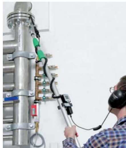
Figuur 1: ultrasone lekdetectie in de praktijk
