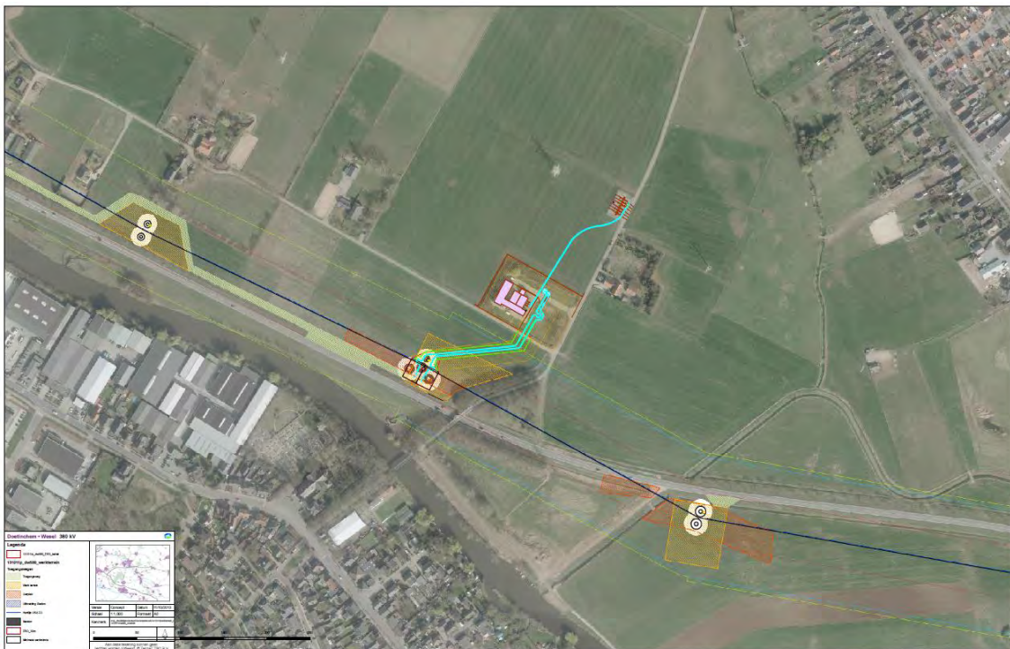
Abbeelding 7 Afstijgpunt mast 38 naar station Ulft.
