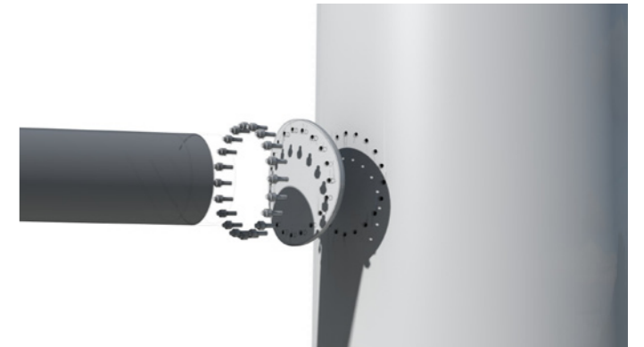
minimale flens > de verbinding zal niet verder uitsteken dan 0,03 \cdot D (D= diameter t.p.v. aansluiting), met een minimum van 25mm. De verbindingplaat is conisch zodat hij gelijkmatig uitsteekt aan alle zijdes De bouten steken niet verder uit de verbindingplaat dan 25mm.
