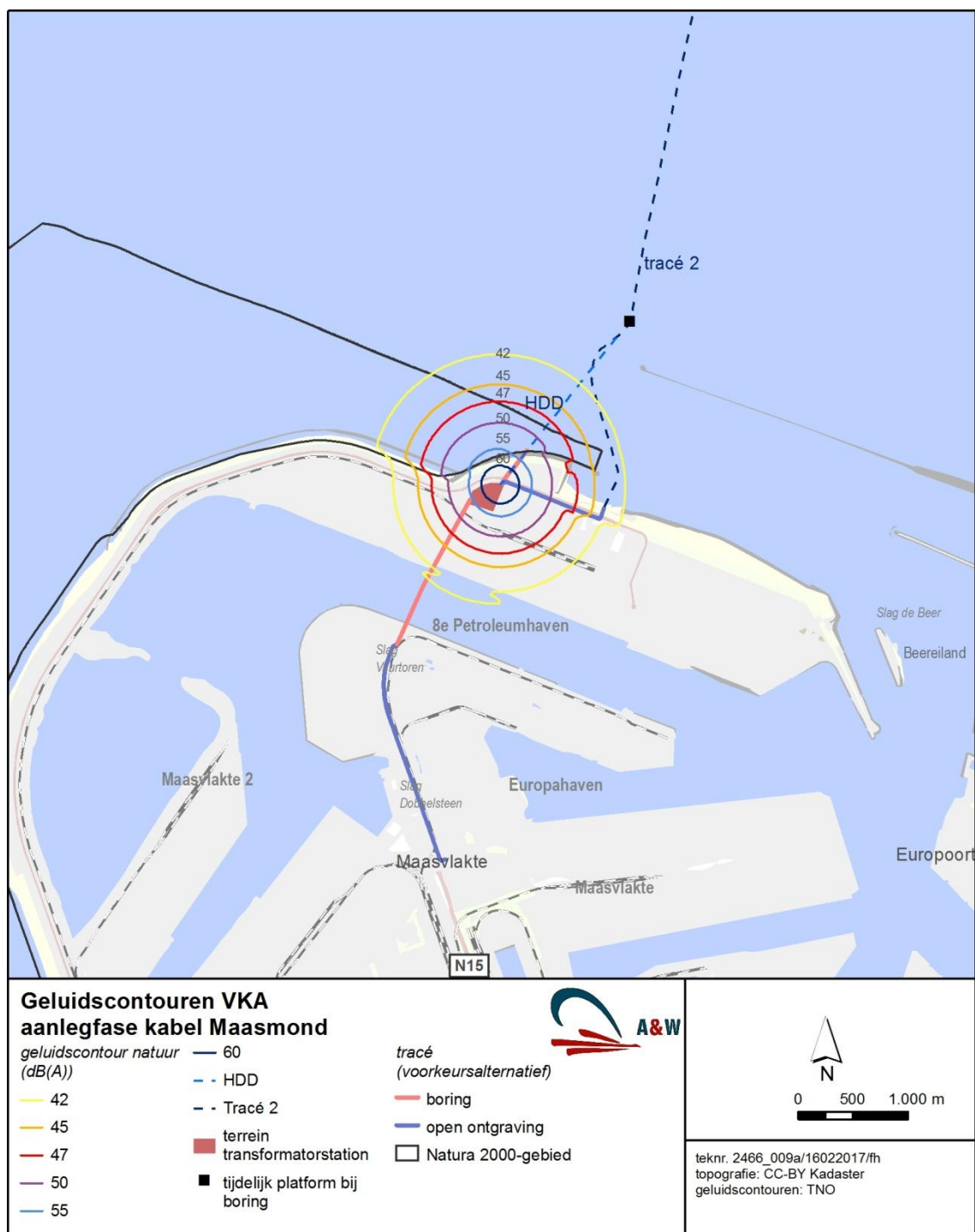
Afbeelding 6.2b Aanlegfase: Geluidscontouren rond HDD boring Maasmond
