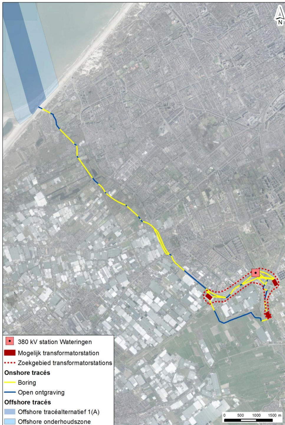
Afbeelding 4.15 Aanlegmethoden (open ontgraving/gestuurde boring) tracéalternatief 1(A)
