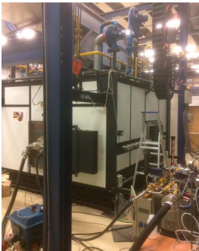
Demo industriële oven (links) aangestuurd met de Sustainoflame regeling die gekoppeld is aan een brandermanagementsysteem (rechts)
