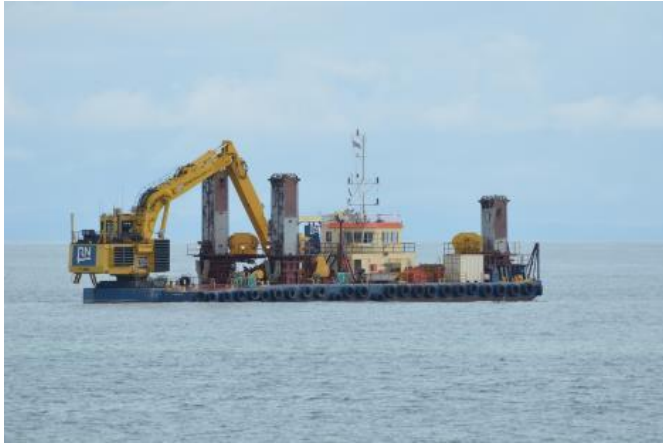
Afbeelding 3.5 Back-hoe (graafmachine) op ponton
