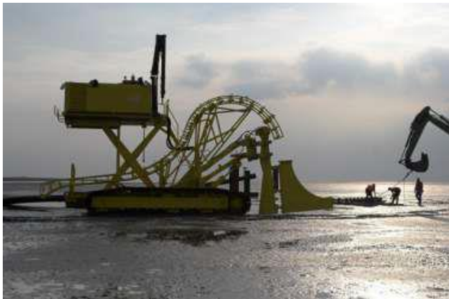
Afbeelding 3.7 een 'wadtrencher' op rupsbanden
