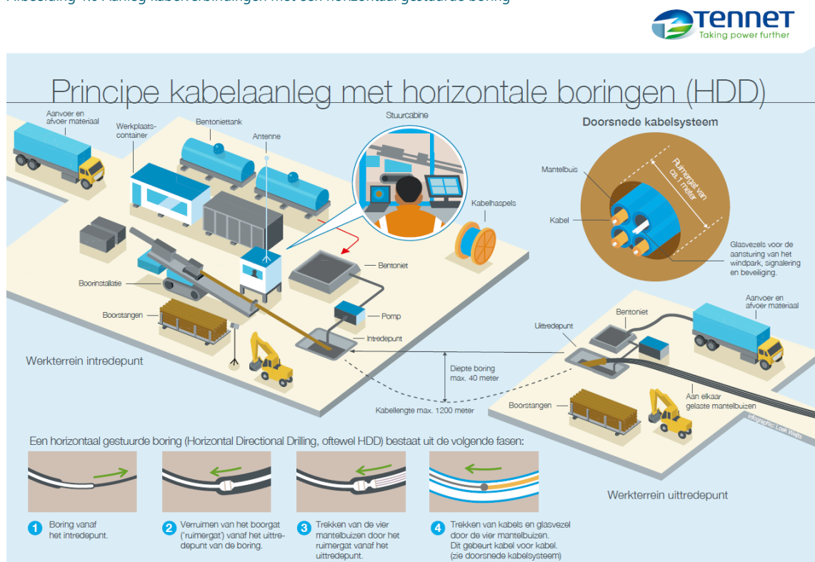
Afbeelding 1.6 Aanleg kabelverbindingen met een horizontaal gestuurde boring
