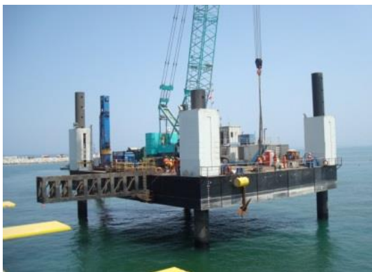
Afbeelding 3.6 Voorbeeld van een jack-up platform
