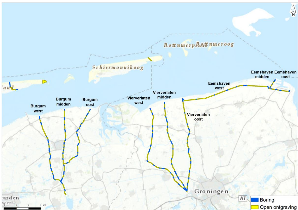
Afbeelding 2.1 Installatiemethodes op land voor de negen tracéalternatieven
