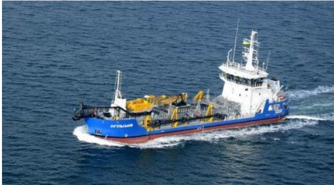
Afbeelding 3.3 Relatief kleine sleephopperzuiger met weinig diepgang
