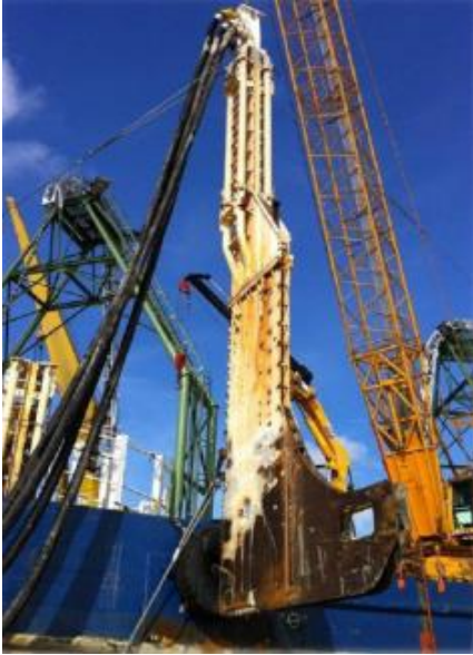
Afbeelding 3.8 Voorbeeld van een Vertical Injector zwaard
