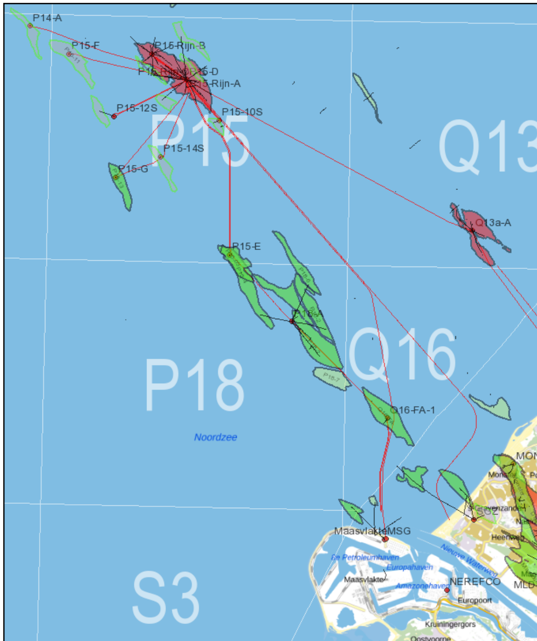
Figuur 4.2. Kaart van P18 en directe omgeving. Gasreservoirs zijn groen en oliereservoirs zijn rood, pijpleidingen zijn rood (bron: NLOG)
