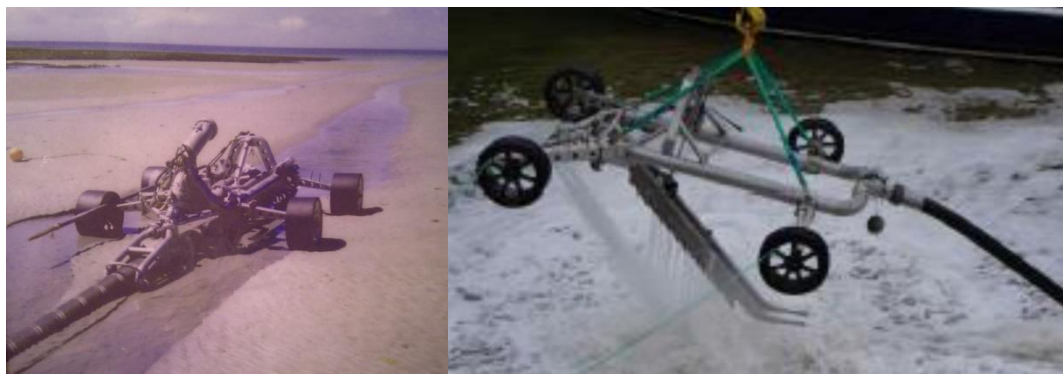
Figuur 9 Jet-trench gereedschap op wielen dat wordt gebruikt om de kabel in te graven tussen de laagwaterlijn en de CBT 1100.
