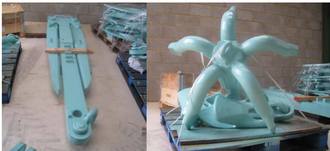
Figuur 2 Detranching anker (links) en speerpunt en Giffords anker (rechts).
