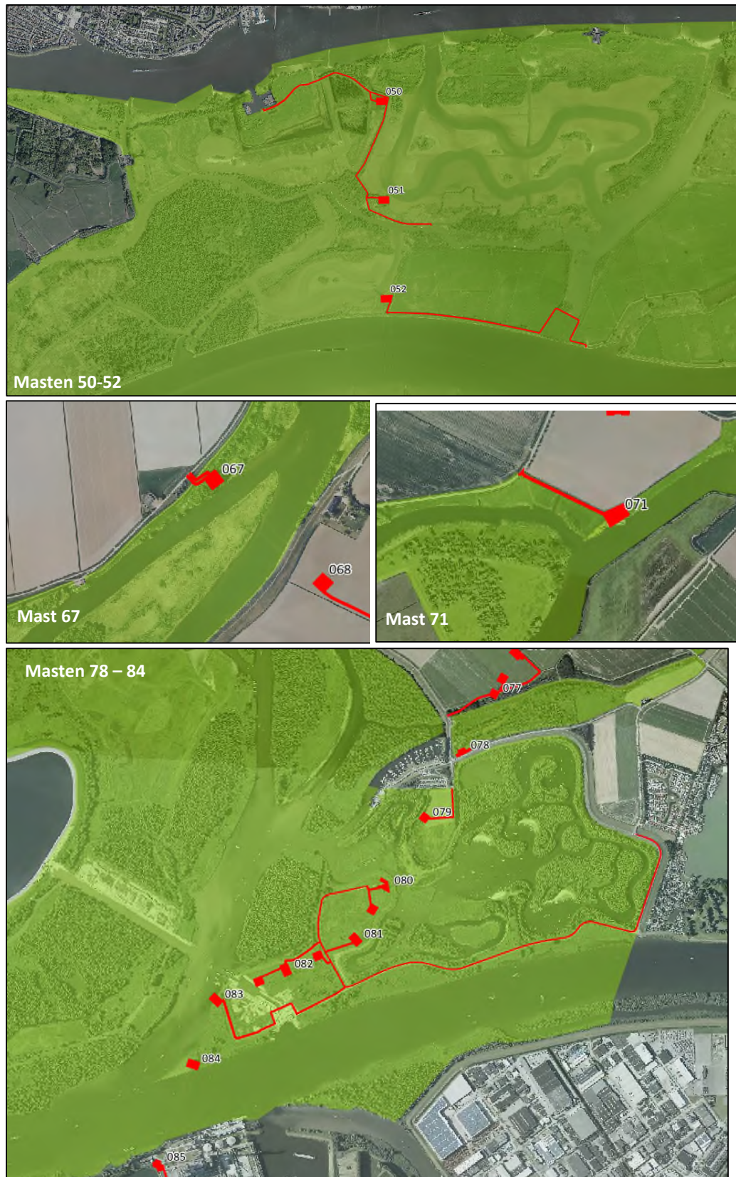
Figuur 5.2. Ligging werkterreinen, lierlocaties en aanrijroutes (rode lijnen/vlakken) binnen de grenzen van het Natura 2000-gebied Biesbosch (geelgroene kleuring/filter), gebaseerd op mastenboek 1-4-1.
