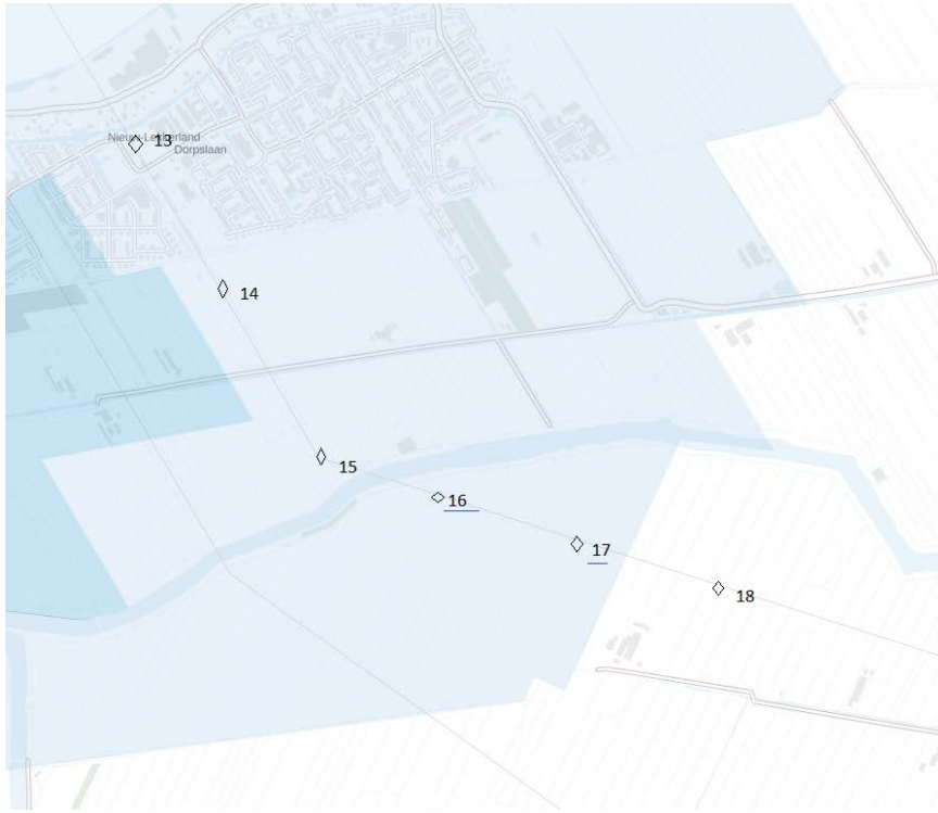
Figuur 2 Verbinding Krimpen aan/den IJssel – Geertruidenberg masten 13 t/m 17 (mast 18 ligt buiten de beschermingszones). Masten gelegen in boringsvrije zone (lichtblauw), grondwaterbeschermingsgebied (blauw) en waterwingebied (donkerblauw). De mastnummers die onderstreept zijn betreffen masten waar de fundatie versterkt wordt. Masten zijn bij benadering ingetekend.
