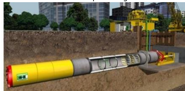
Figuur B17 - Microtunnel installatie
