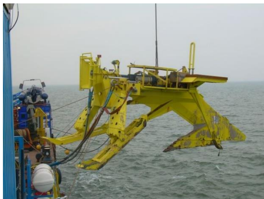
Figuur B13 - Een ploeg voor kabels en kleine leidingen
