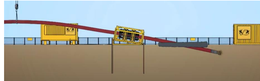
Figuur B20 - Van Leeuwen Sleufloze Technieken: direct drill techniek
