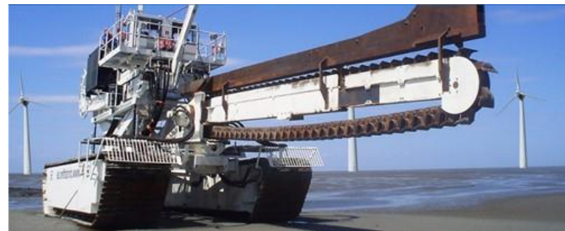
Figuur B6 - Trenchervoertuig met kettinggraver
