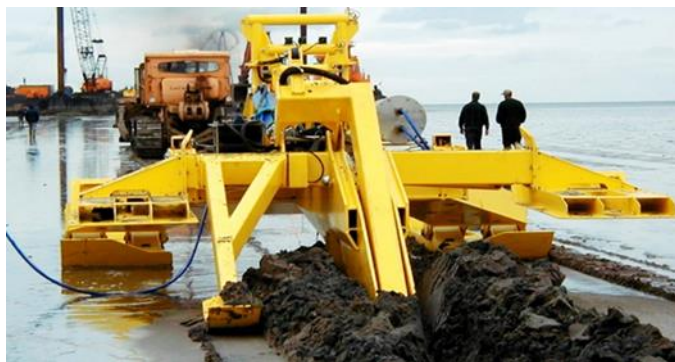
Figuur B7 - Ploeg met slede (Foto: IHC Sea Stallion)
