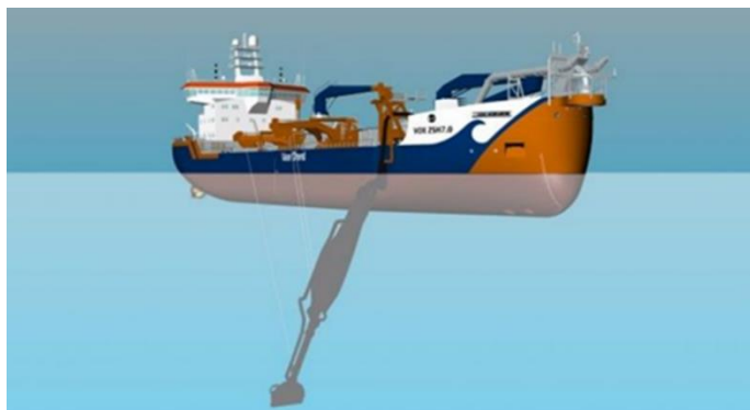
Figuur B11 - Sleephopperzuiger (illustratie van Oord)
