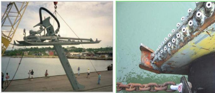
Figuur B8 - Jet-injector op slede (links) en spuitkoppen op de lans (rechts)
