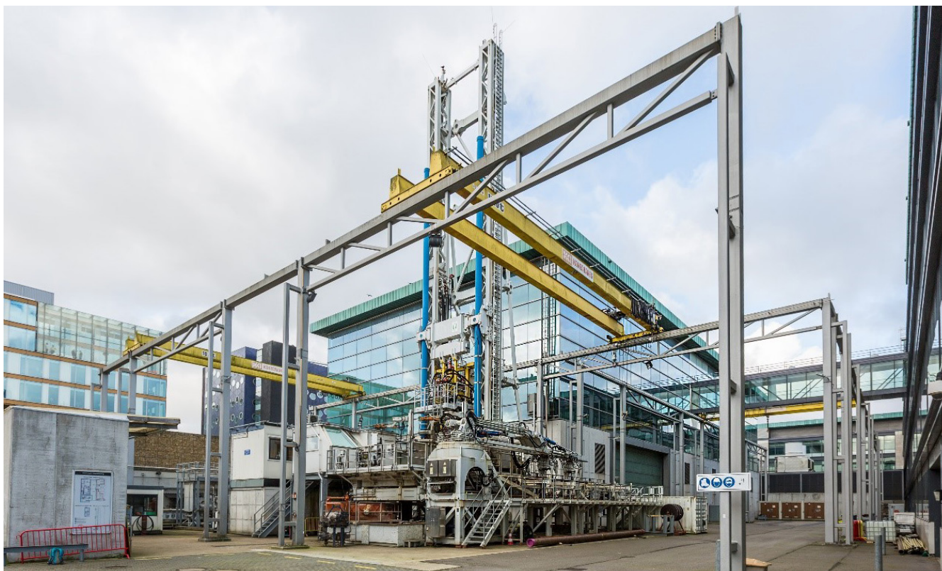
Een groot deel van de testen voor het DRAGLOW-project wordt gedaan in het Rijswijk Centre for Sustainable Geo-energy' (RCSG), een uniek fieldlab waar aardwarmteprojecten op ware schaal getest kunnen worden.
