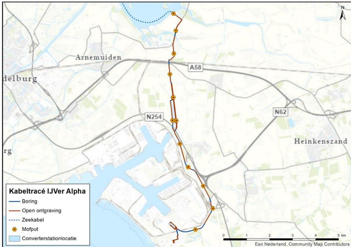
Figuur 2.6 Kabeltracé IJmuiden Ver met de locaties van de mofputten (bij benadering).
