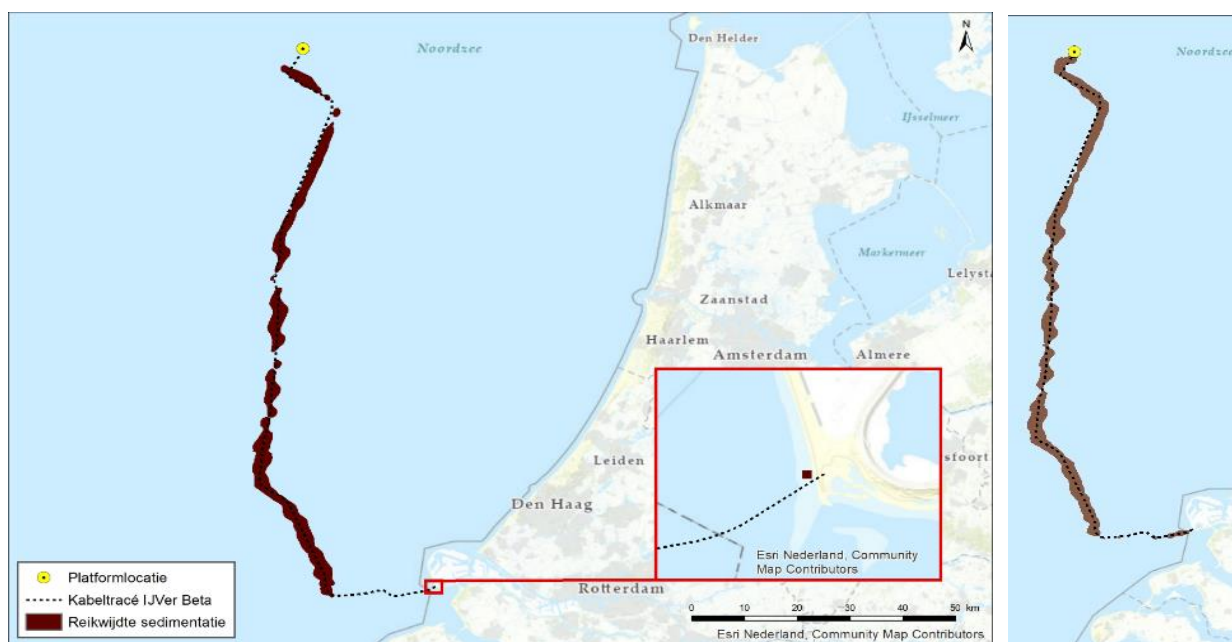
Figuur 29 Gebieden waar de sedimentatie per dag boven de grens van 0,33 mm/dag uitkomt voor de (1x4)-kabelconfiguratie (links) en de (2x2)-kabelconfiguratie (rechts)
