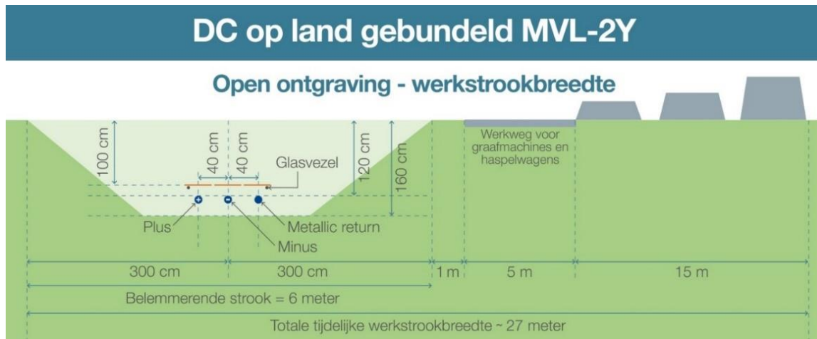
Figuur 2.6 De kabelconfiguratie en werkstroombreedte bij open ontgraving van Net op zee IJmuiden Ver Beta.
