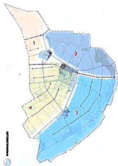
Figuur 3: Zones 1, 3 en 4 zijn zoekgebieden voor grote windturbineopstellingen; zone 2 wordt gevrijwaard van windturbines om de openheid te bewaren. De pijlen geven de hoofdrichting van de verkaveling van de polder aan, waar opstellingen parallel aan moeten komen te staan.
