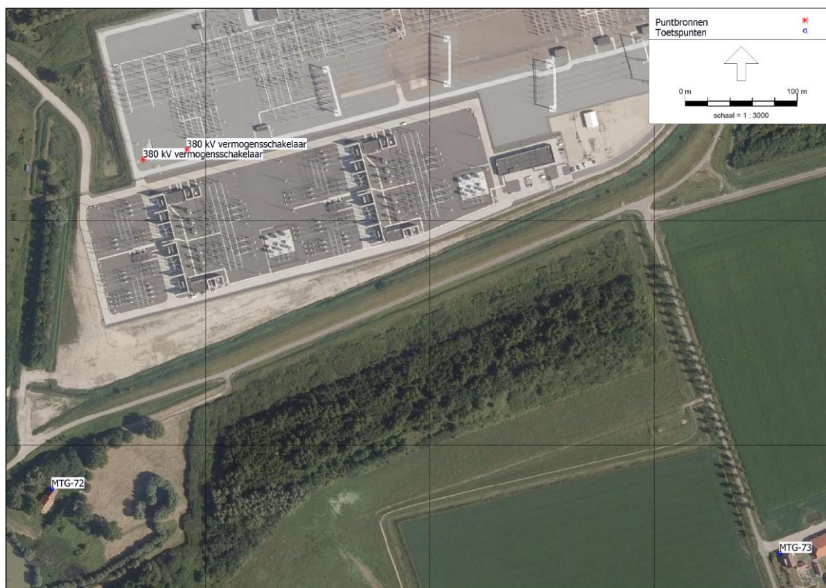
Figuur 6 Posities van de geluidbronnen (vermogensschakelaars) en de dichtstbijzijnde woningen Weelhoekweg 10 (MTG-72) en Weelweg 20 (MTG-73)
