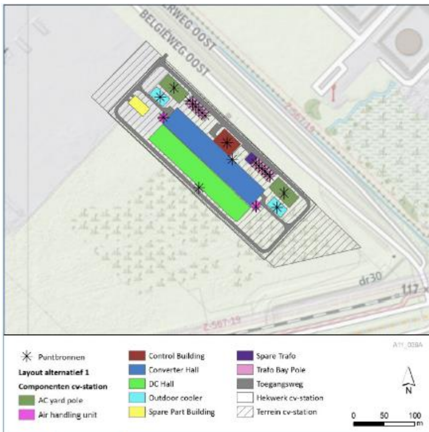
Figuur 5.16. Geluidbronnen converterstation Borssele
