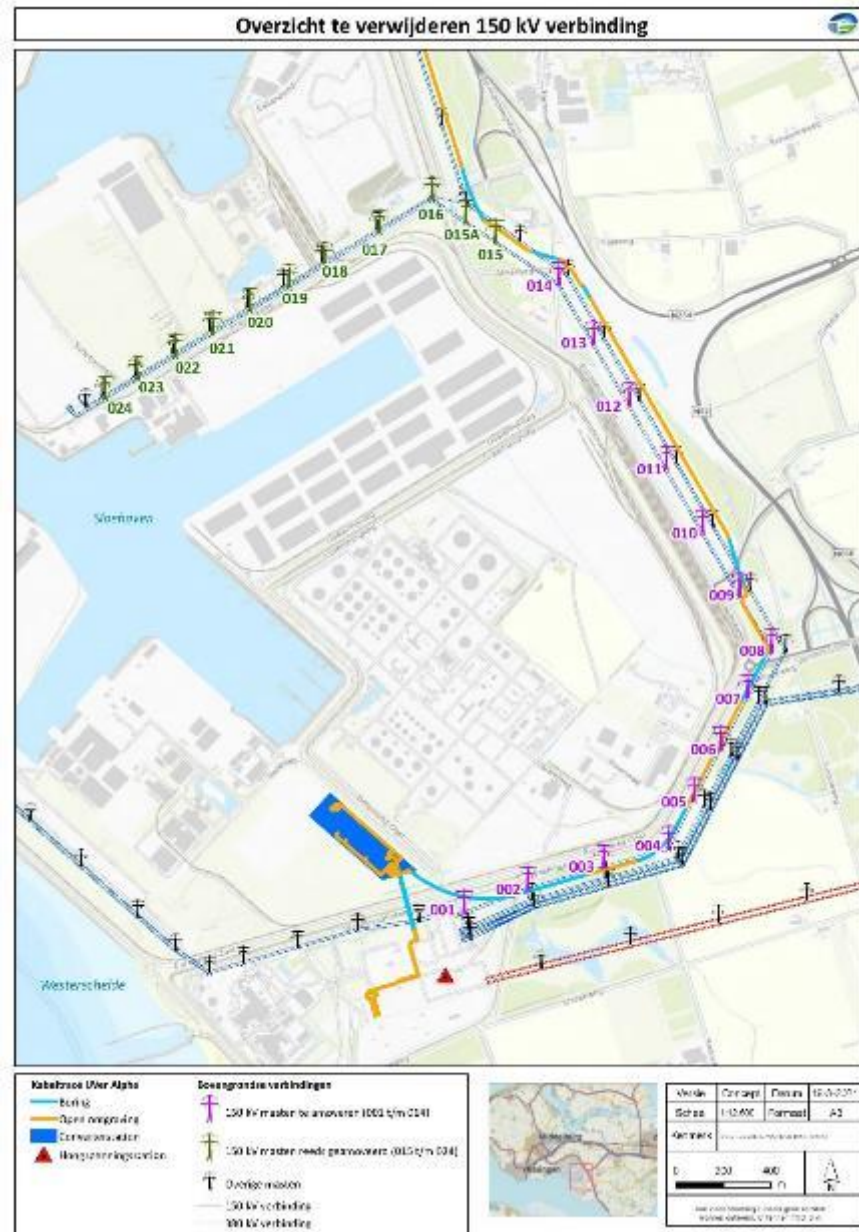
Figuur 2.12 Overzicht te verwijderen deel bovengrondse 150 kV-verbinding BSL-PCN150
