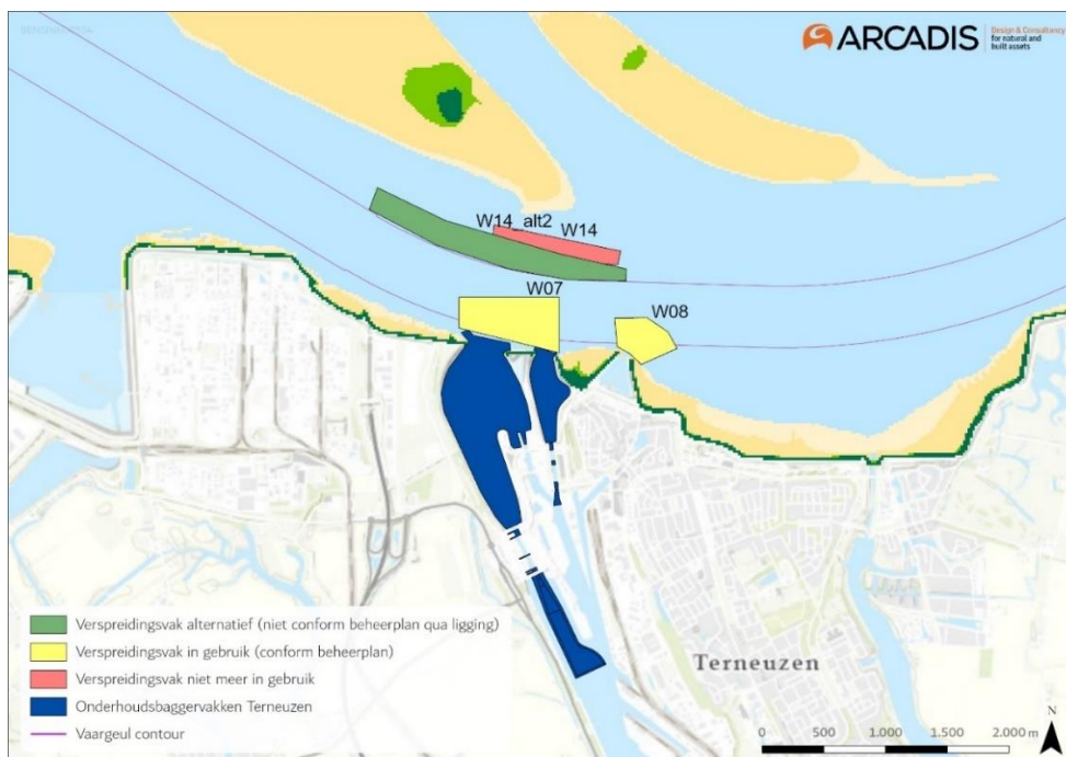
Figuur 3-1 De onderhoudsbaggervakken bij Terneuzen met het alternatieve verspreidingsvak W14_alt2, dit verspreidingsvak vervangt het niet-toekomstbestendige verspreidingsvak W14, dat niet meer in gebruik is. De verspreidingsvakken W07 en W08 zijn conform bestaand gebruik en zijn daarom niet verder behandeld.
