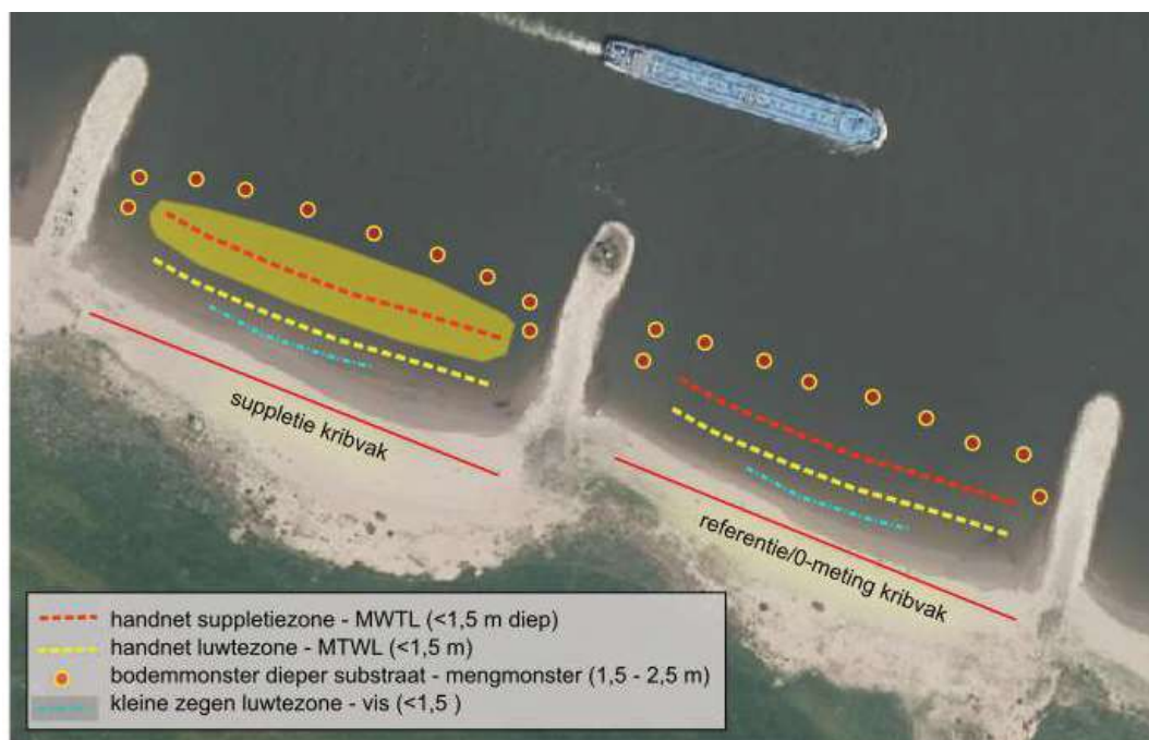
Figuur 5.1. Schematisch ecologisch meetplan kribvaksuppletie. Weergegeven zijn een kribvak waar gesuppleerd wordt (links – ontwerp 2) en een referentiekribvak (of nulmeting voor suppletie, rechts). In de ondiepe (suppletie/luwte)zone (<1,5 m) wordt per kribvak één zegentraject (vis, Wnb-soorten) en twee macrofaunamonsters met handnet verzameld (Wnb- en KRW soorten). De weergegeven monstertrajecten in de ondiepe zone zijn bij benadering; in deze trajecten moet één zegentraject bemonsterd worden (35 m lang) en twee macrofaunamonsters verzameld worden (elk monster traject 5 m lang, niet aaneengesloten maar verspreid over alle bodemtypes). In de aangrenzende, diepere zone (1,5 – 2,5 m) wordt per kribvak tien bodemonsters (bodemhapper, hevelzuiger) verzameld voor een quickscan Wnb-soorten (rivierprik en rivierrombout) en biobuilders, de tien monsters worden gecombineerd tot één macrofauna mengmonster (KRW soorten).
