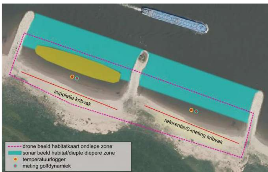
Figuur 5.2. Schematisch abiotisch meetplan kribvaksuppletie. Weergegeven is een kribvak waar gesuppleerd (links) en een referentie kribvak (of nulmeting voor suppletie, rechts). Golfdynamiek wordt gemeten in de luwte-zone achter de suppletiezone en vergeleken met de referentie; watertemperatuur wordt gemeten met een infrarood drone beeld en vergeleken met een temperatuurlogger in de ondiepe zone van beide kribvakken. Van elk kribvak wordt een habitat- en dieptekaart gemaakt tijdens de ecologische monitoring op basis van een drone-luchtfoto en sonarmeting. Stroomsnelheden in de kribvakken kunnen in beeld gebracht worden met een hydrografisch ADCP vaartuig. Ter hoogte van de temperatuurlogger worden zuurstof puntmetingen uitgevoerd tijdens de ecologische monitoring.
