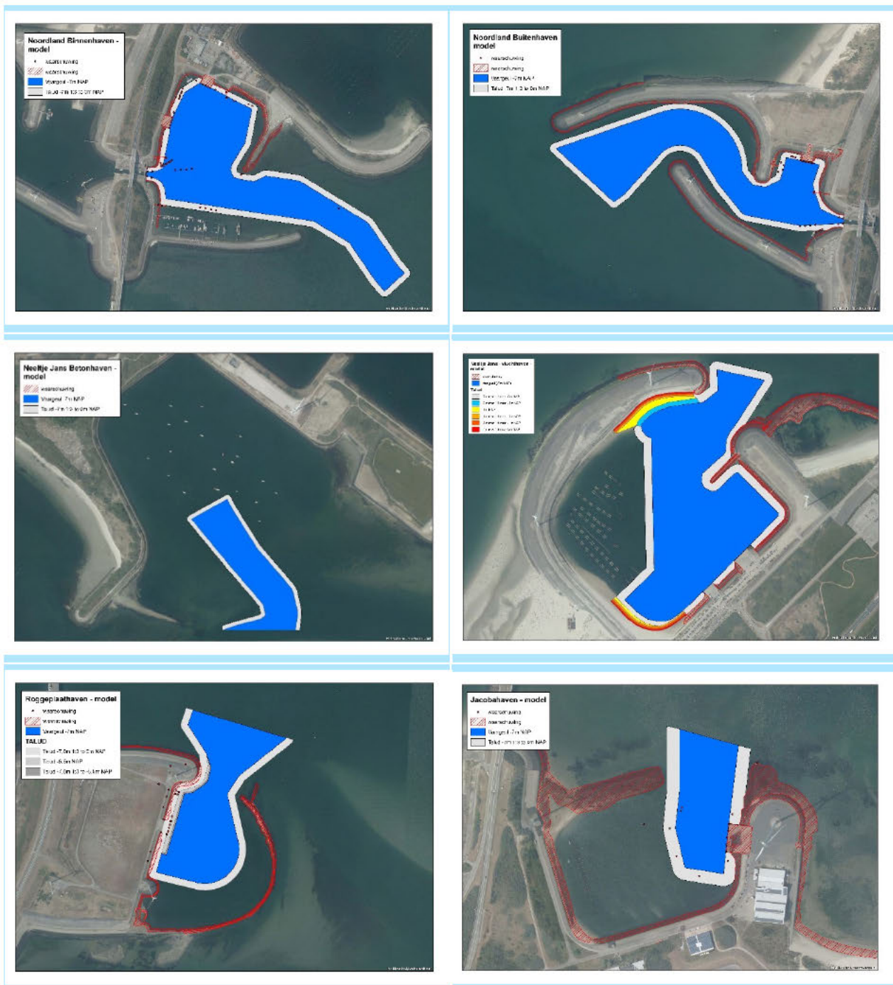
Figuur 3-3 Baggervakken Oosterscheldekeringhavens (Bron: gegevens Rijkswaterstaat)
