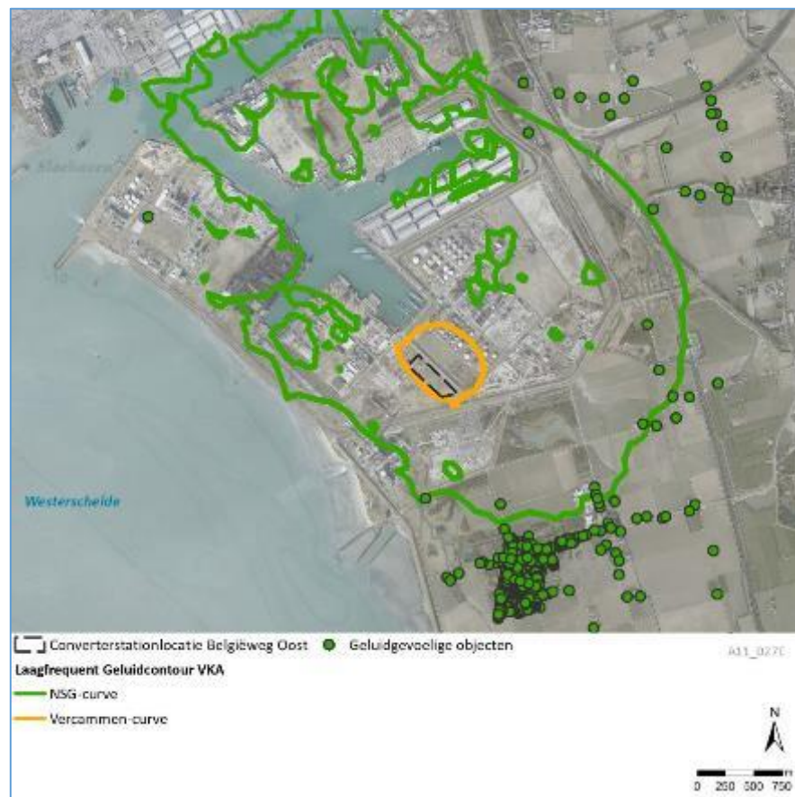
Figuur 5.18. NSG-curve en Vercammen-curve laagfrequent geluid grenswaardecontouren
