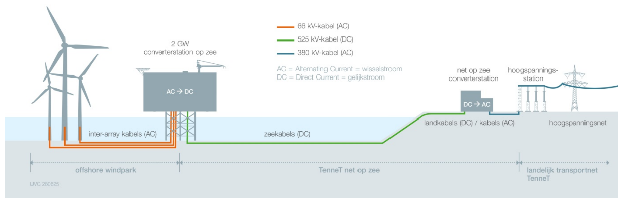
Figuur 2: netconcept met onderdelen van de 2GW-verbinding
