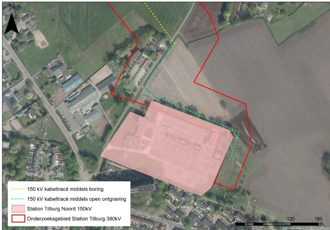
Figuur 6: Luchtfoto met locatie Station Tilburg Noord en de tweede open ontgraving van 150kV kabeltracé.
