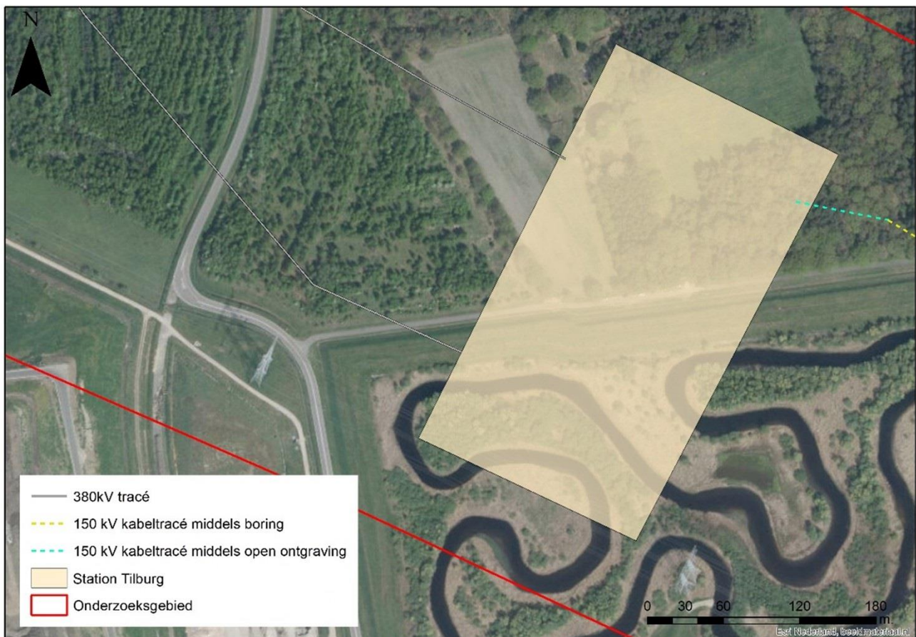
Figuur 2: Luchtfoto met detail van de locatie 380kV hoogspanningsstation, aansluiting op het 380kV-tracé (westzijde) en de eerste open ontgraving van 150kV kabeltracé (oostzijde).
