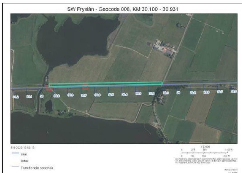
Figuur 3. Aan te leggen ontsluitingswegen (groen) met de op te heffen NABO's (rood).
