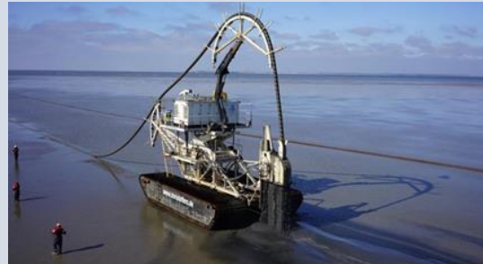
Afbeelding 4-4: Voorbeeld van een Wadtrencher
