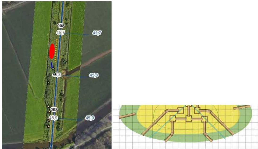
Figuur 3: locatie kunstburcht (rode ovaal). De sterren geven indicatief de locatie van de burcht met de pijpen weer waarbij een ster voor meerdere pijpen kan staan. Rechtsboven locatie kunstburcht en linksonder basisprincipe kunstburcht
